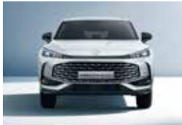
Εμπρός μετατρόχιο 1.590mm Πλάτος (με καθρέπτες) 2.066mm
